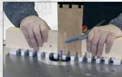
Utilisation du gabarit HMDiffusion à la toupie Attention : les protecteurs ont été enlevés pour une meilleure clarté de la vue.
