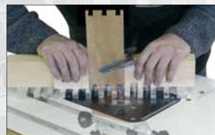
Utilisation du gabarit HMDiffusion avec une défonceuse montée sous table Attention : les protecteurs ont été enlevés pour une meilleure clarté de la vue.
