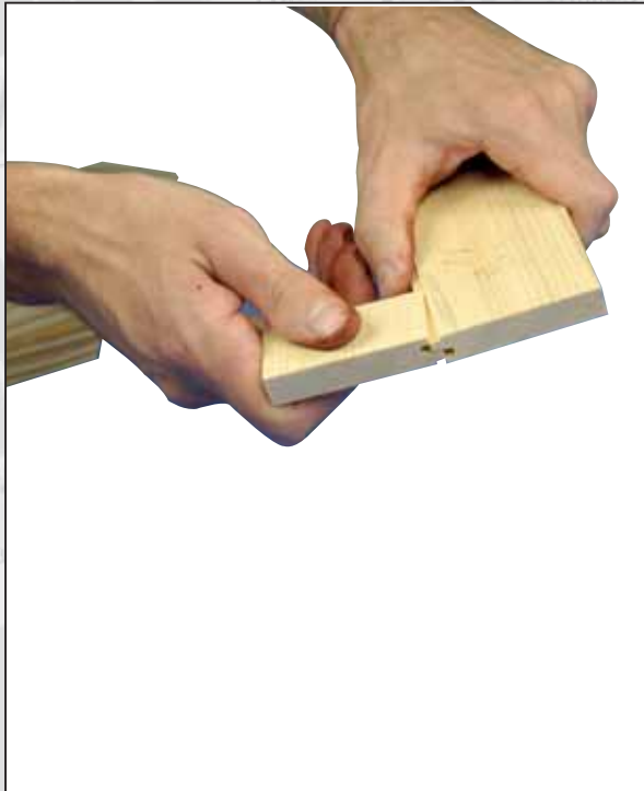
Vue n° 6 : contrôle de l'affleutage : sur une pièce d'essai
