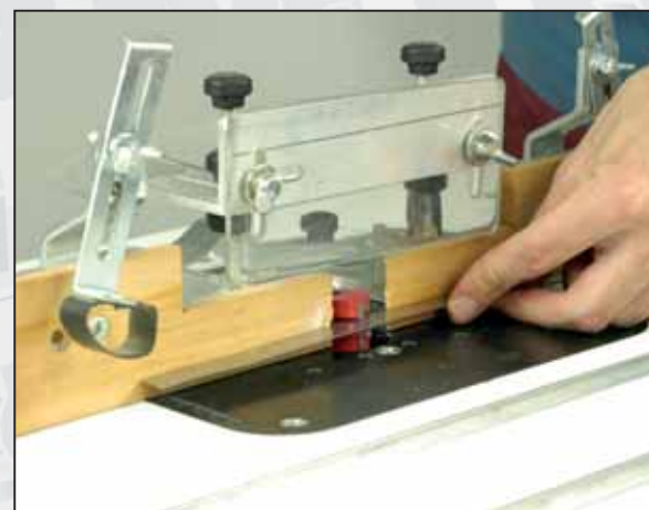
Vue n° 5 : réglage du guide parallèle au réglet, ce réglage déterminera la largeur de coupe.
