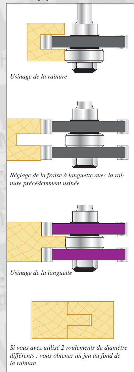
Schéma 19 : Usinage d'une rainure et languette
