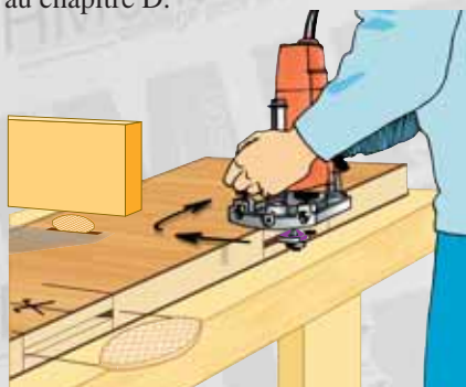
Schéma 11 : la pose de lamelles à la défonceuse.
