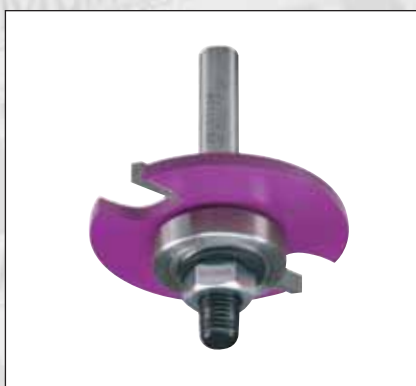
Photo 1 : attention au sens de montage des disques sur l'arbre.
