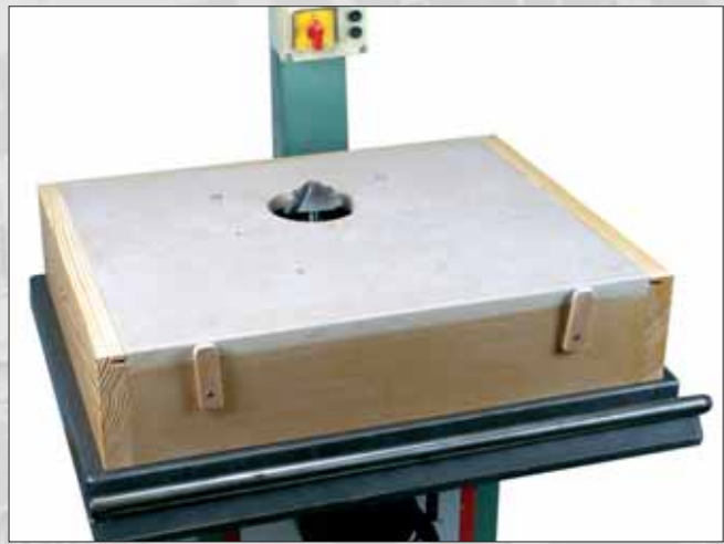
Vue d'ensemble avec la fausse table en place et une fraise de grand diamètre. Inserts à visser pour la fixation du guide.
