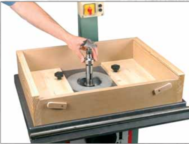
Fixation du porte-fraises en bout d'arbre. Avant d'installer la fausse table sur le caisson, descendez l'arbre au maximum afin qu'il ne gêne pas le coulisage de cette dernière.
