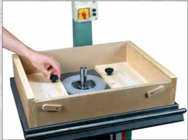
Fixation du caisson au moyen de 2 boutons de serrage. Les perçages effectués dans le caisson pourront être légèrement oblongs, laissant ainsi une marge de réglage pour aligner le porte-fraises avec le "rond de poêle" de la fausse table.
