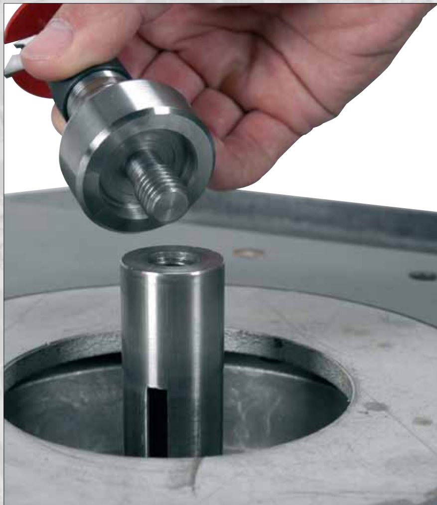
En partie basse, un filetage M14 (ou M16) x 15 mm et une collerette Ø 30 mm chanfreinée pour faciliter la mise en place et optimiser le centrage sur l'arbre de toupie.
