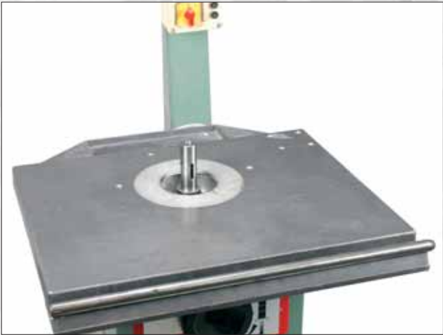
Vue d'ensemble de la table de la toupeuse avec les trous filetés pour la fixation du caisson de la fausse table.
