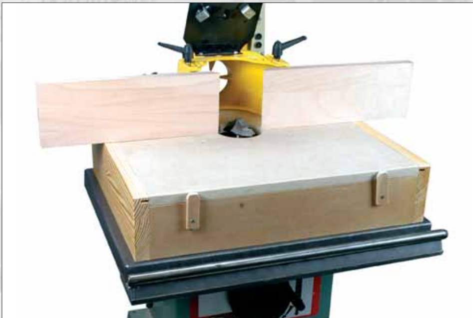
La fausse table montée sur la toupeuse avec le guide en place.
