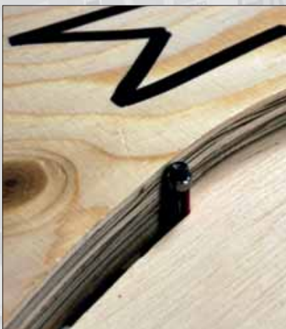
Photo n° 4 : découpe à la fraise à copier, le guide à bille suit parfaitement le contour du gabarit "Mère" sans jamais s'en écarter.
