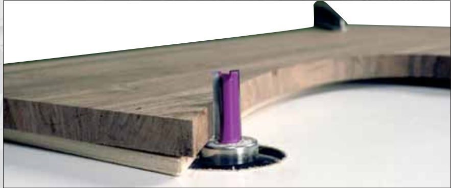
Photo n° 7 : découpe d'un panneau à l'aide du gabarit F ; la fraise à copier Ø 10 mm, guide à bille Ø 22 mm nous permet de "récupérer" les 6 mm manquants sur le gabarit. Attention : (protecteur enlevé pour une meilleure clarté de la vue).
