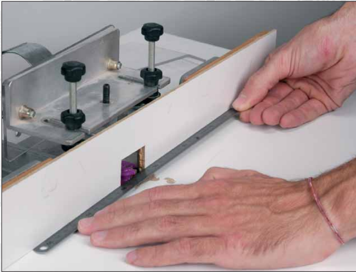
Vue n°4 : réglage en profondeur de la fraise, à l'aide d'un réglet
