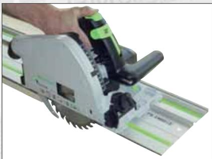
• En sortie de pièce, la scie doit également être guidée par le rail jusqu'à la fin de l'usinage.
