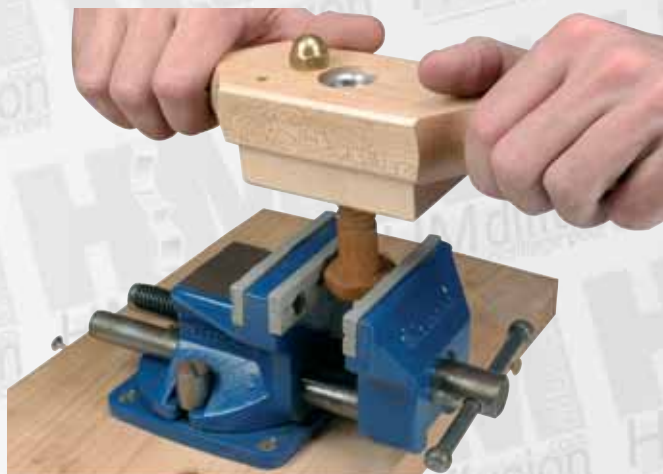
Photo 5 : Pièce maintenue dans un étau lors du filetage.
