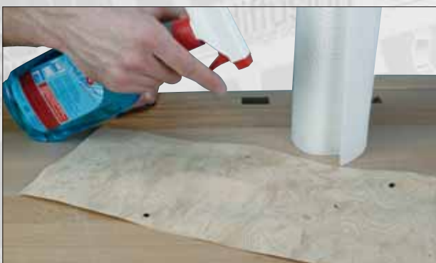
Vue n° 6 : Humidification au vaporisateur d'un placage déformé.
