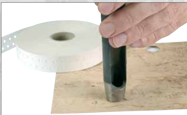
Vue n° 4 : Réparation d'un grain de loupe à l'emporte-pièce : élimination du défaut.
