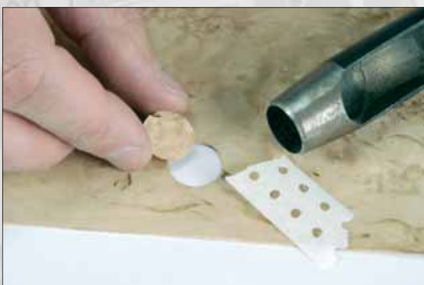
Vue n° 5 : Réparation d'un grain de loupe à l'emporte-pièce : rebouchage.
