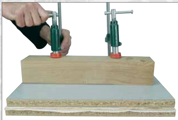
Vue n° 7 : Enrobage du placage entre 2 feuilles de Sopalin et mise sous presse.
