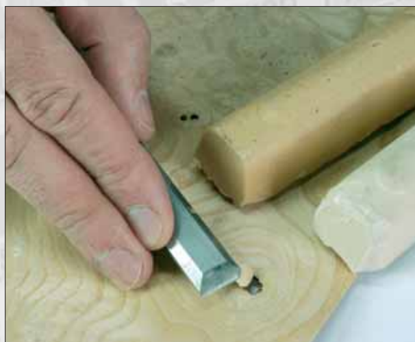
Vue n° 3 : Réparation à la gomme laque d'un «grain ouvert» de loupe.
