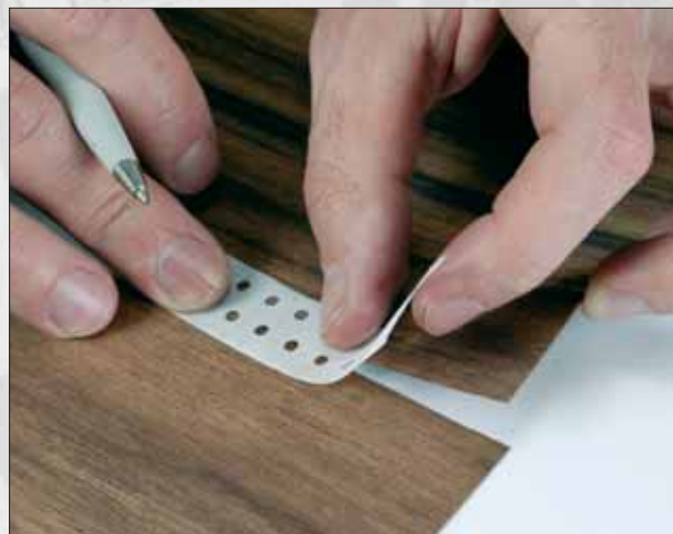
Vue n° 2 : Réparation, à l'aide de papier gommé, d'une fissure en extrémité d'un placage.
