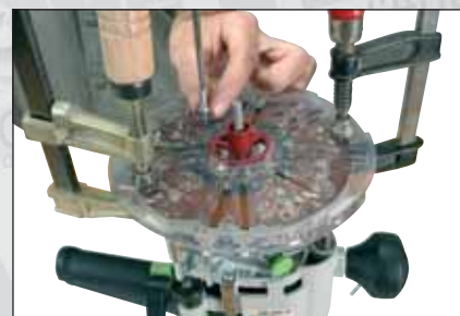
Vue n°D : Fixation de l'embase universelle.
