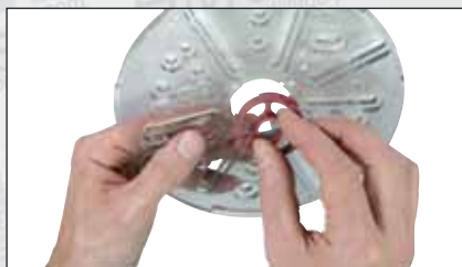
Vue n°B : Montage d'une bague de copiage sur l'embase universelle.
