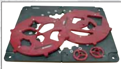
Vue n° 5 : La plaque-support et les 2 gabarits
