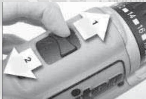
Vue 6 : le sélecteur de vitesse à 2 positions
