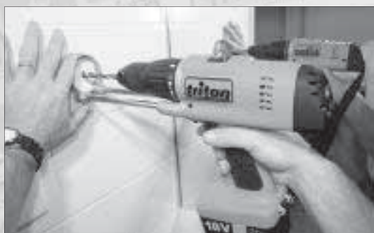
Vue 12 : perçage avec le mécanisme de plongée.
