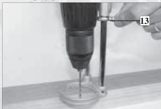
Vue 13 : réglage de la butée de profondeur.
