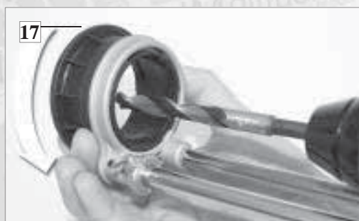
Vue 14 : extension de la base de plongée.
