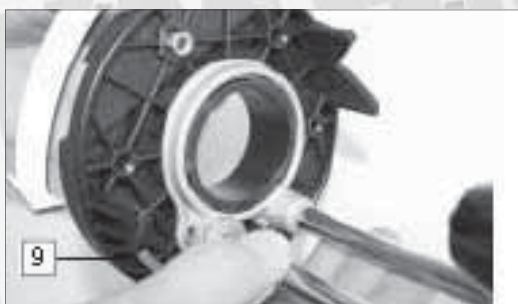
Vue 16 : montage de l'embase en V.
