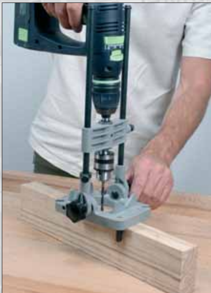
5- Perçage centré sur tasseau.
