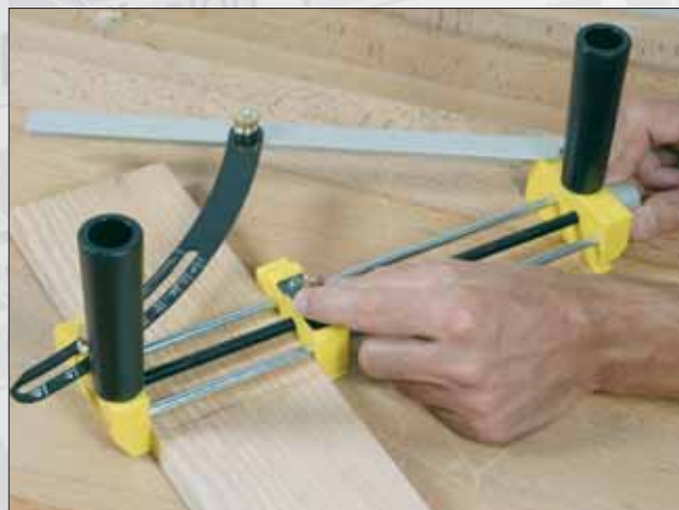
Photo 3 : mise en place des bois pour une utilisation à la scie circulaire.
