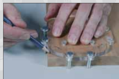
Vue n° 1 : positionnement du gabarit et traçage
