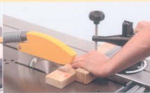
Tronçonnage au chariot
