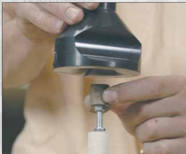
Photo 3 : cale pour «butée de profondeur» équipée d'une vis de réglage.
