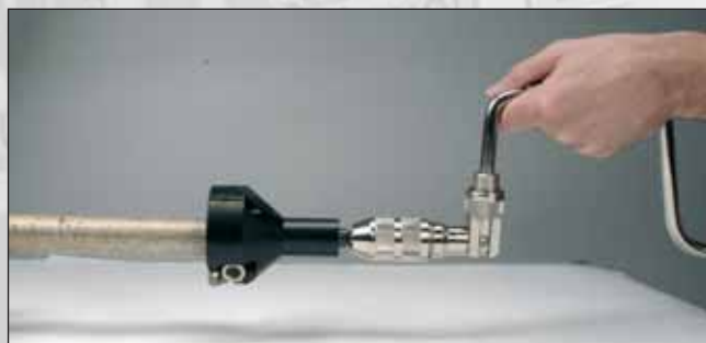
Photo 9 : pour obtenir un tenon droit : tenonnage dans l'axe du bois.
