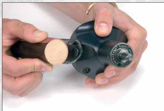
Photo 13 : affûtage de la lame des embouts «gros diamètres» à la cale d'affûtage.
