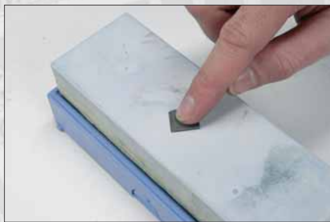
Photo 17 : Affûtage de la planche de la lame sur une pierre d'affûtage.
