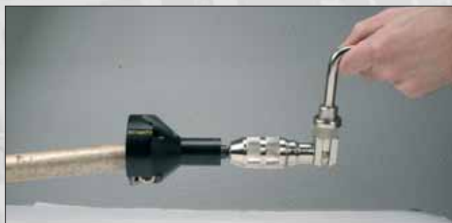
Photo 10 : tenonnage pour un assemblage incliné.
