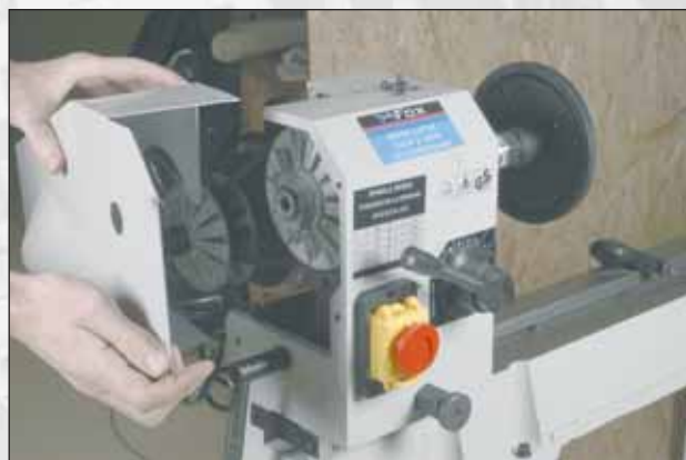
Photos 1 et 2 : démontage du carter de protection.
