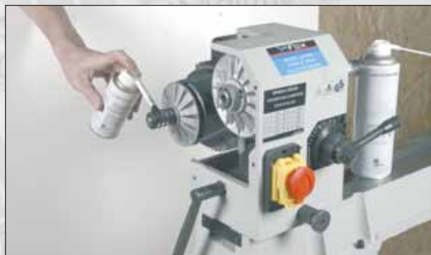
Photo 4 : lubrification des axes des poulies
