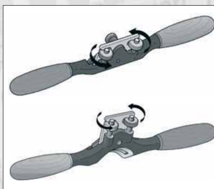
Schéma 3 : Réglage de la profondeur de coupe : actionnez les 2 mollettes de réglage (dans le même sens et exactement de la même valeur).
