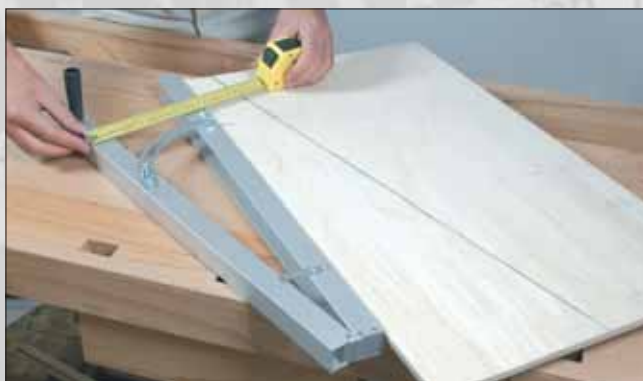
Photo 2 : réglage du guide par mesure
