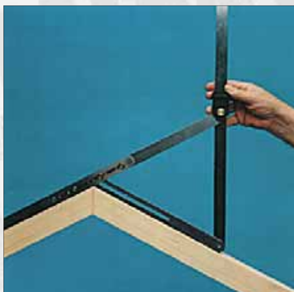
Mesure d'un angle extérieur
