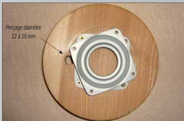
Photo 3 : perçage du socle afin de pouvoir visser le mécanisme sur l'envers du plateau.
