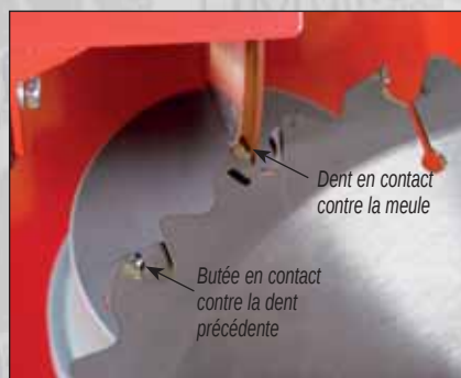
Photo 14 : affûtage avec la butée (notez qu'une dent sur 2 a été marquée avec un feutre noir).
