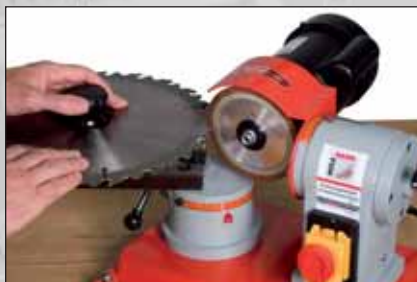
Photo 5 : montage d'une lame (la lame doit toujours pouvoir tourner sur elle-même : ne jamais totalement bloquer la molette de serrage).
