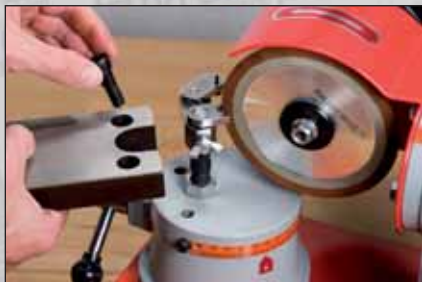
Photo 3 : montage du bras-support.
