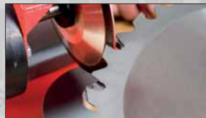
Photo 12 : réglage de l'angle d'attaque frontal : la face de la dent est parfaitement plaquée à plat contre la meule.
