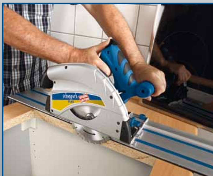
Découpe parfaite dans les plans de travail, seulement possible avec une scie plongante. Même un amateur peut réaliser des coupes parallèles sans éclats en utilisant le rail (en option)
