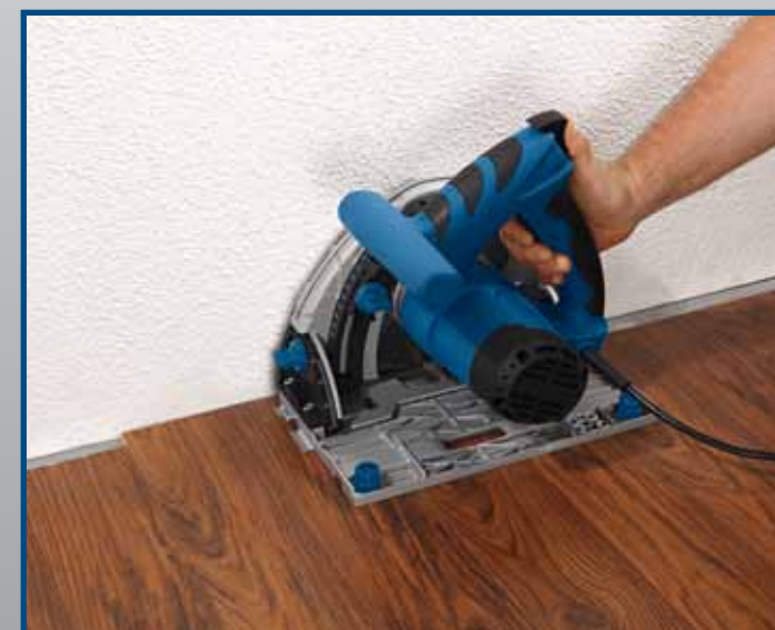
Idéale pour araser jusqu'à 16 mm du mur. Encore un avantage de cette scie
