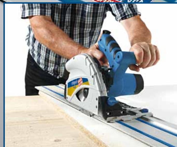
Permet de réaliser un débit de panneau parfaitement rectiligne qui n'est généralement obtenu qu'avec une scie à formats
